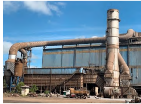
ภาพที่ 2.2-2 ระบบดักฝุ่นแบบถุงกรอง Bag Filter House
